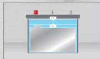
Nieuw design met lager geplaatste platen voor een grotere vloeistofinhoud
